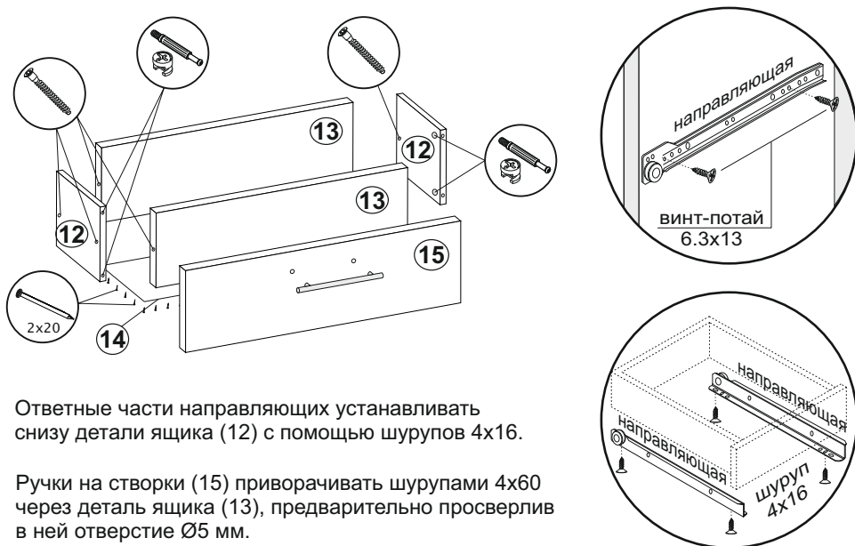
Рис.7 Сборка выдвижного ящика
