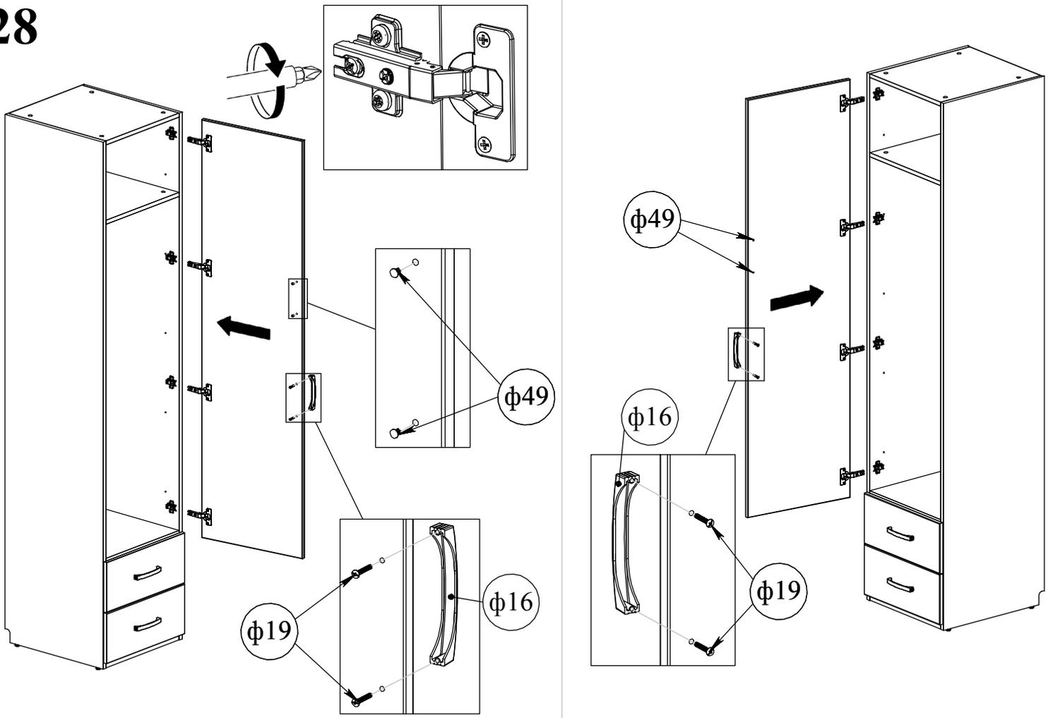
29 Не задействованные в процессе сборки отверстия закрыть заглушками -  $\phi 49$
