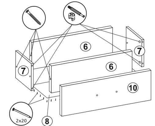
Ручку на створки (10) приворачивать винтами M4x10. Ответные части направляющих устанавливать по центру деталей ящиков (7) шурупами 4x16.
